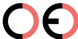
Faux marquage CE (trop éloigné)
